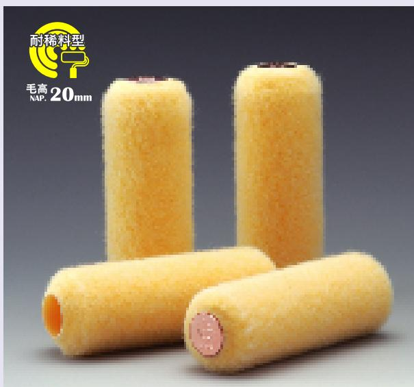
滾筒毛絨的中心和表面采用不同特性的纖維，使滾筒刷具有較高的塗料含有率，同時又富有彈性，粗糙面上也可使用，塗面厚而均勻，工作效率高，屬外牆塗刷用的高檔滾筒刷。
